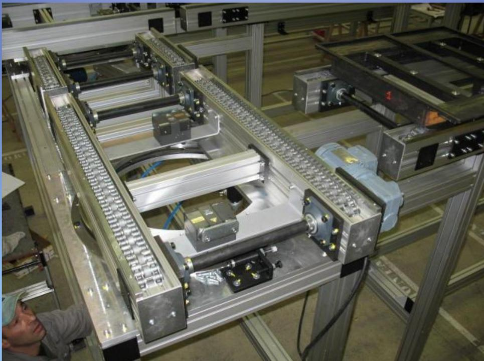
Convoyeurs à chaîne à accumulation TRH
